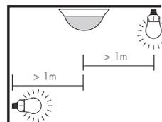
Distance minimum de l'éclairage allumé, de face ou latéral par rapport à l'appareil: 1 m. Ne jamais monter l'éclairage au-dessous du détecteur de mouvement.
